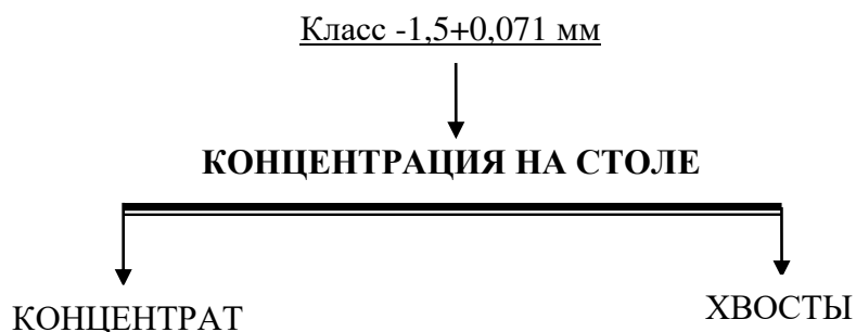
Рисунок 9 – Схема концентрация на столе класса крупностью -1,5+0,071 мм
